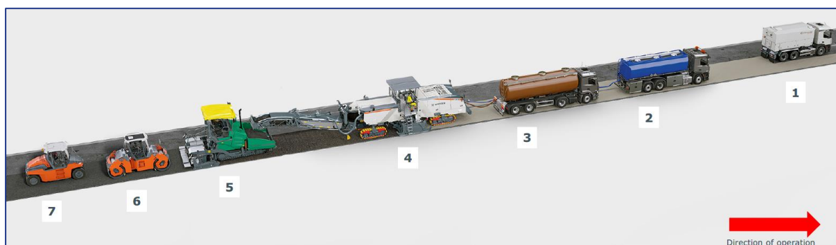
Fig. 4.2: "Udlægningstog" for in-situ BSM produktion og udlægning (kilde: Wirtgen).
