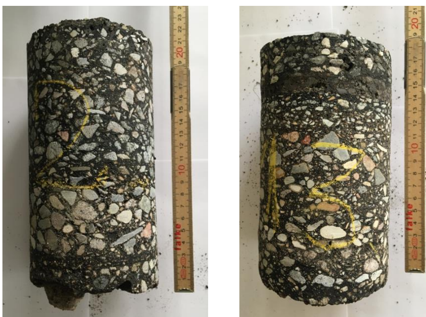
Fig. 3.1: Eksempler på borekerner af gamle asfalt fra henholdsvis den nordlige og sydlige del af strækningen. Enkelte steder kunne ikke optages intakte kerner.
